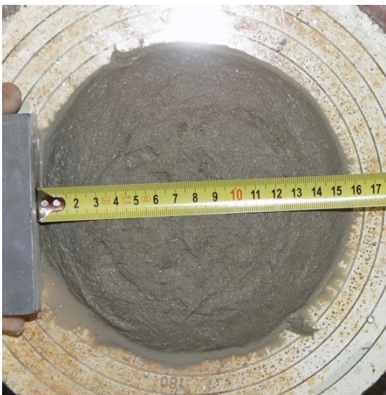
Рис.6 Тест на "оседание" системы с KV12
